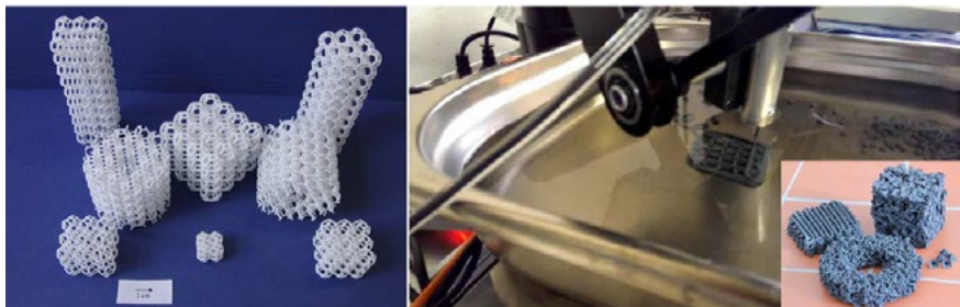
Abb. 15: Links generatives Hybridflammspritzen [Pat17a], computerunterstützte Strukturfertigung mittels der Alginate route, [Pat16a].
