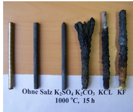
Abbildung 5: Stahlprüfung im Tiegeltest: Prüfung bei 1000°C bei einer Haltezeit von 15 h, von links nach rechts: neue Stahlprobe, Stahlprobe nach Prüfung ohne Salz, mit K_2SO_4 , K_2CO_3 , KCl bzw. KF
