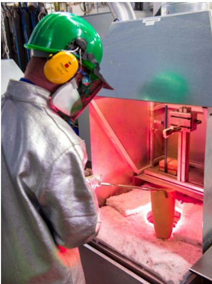
Abb. 1: Arbeiten am Tiegelofen Quelle: Detlev Müller
