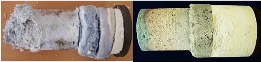
Abbildung 7: links: REFRAZIRCON Z AR von 2013, rechts: REFRAZIRCON Z AR von 2015 Jeweils nach 9 Zyklen im Gradientenofen, von links nach rechts: 1050°C heiße Seite des REFRAZIRCON Z AR mit 60 bzw. 80 mm, weißer Wärmedämmstoff SILCAL 1100, dunkle Stahlröhre mit einer Temperatur von 150°C.
