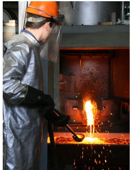
Abb. 2: Abstich an der TSL-Badschmelzanlage Quelle: INEMET
